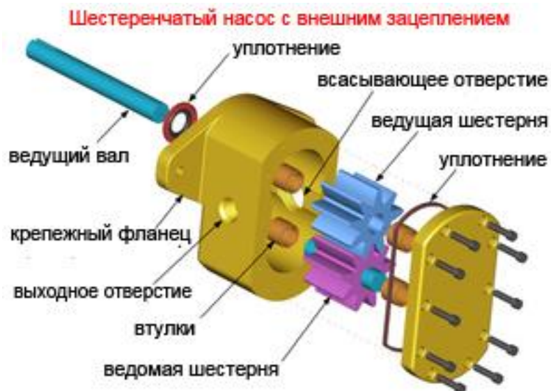
Рисунок 1.14 – Устройство шестеренного насоса с внешним зацеплением
